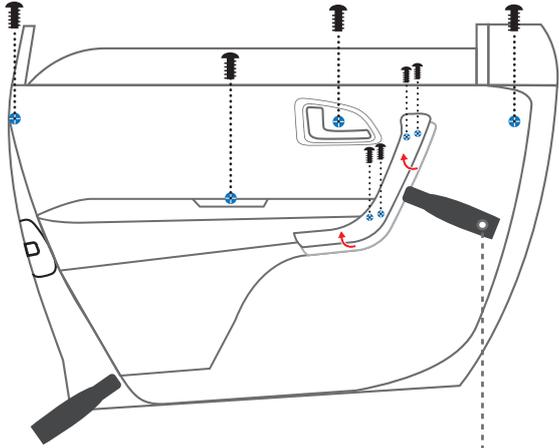
Retire com cuidado a capa do puxador da porta e a capa dos parafusos, em seguida retire os parafusos para remover o forro da porta e iniciar a instalação.
